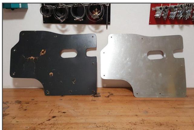
Exemple de portière avant et après réparation par le CVHS
